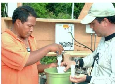
Figura 2: O tuxaua Saravi Deni tira amostra para fazer um teste-rápido microbiológico da água do igarapé Maharí tratada pelo protótipo do sistema de desinfecção da água instalado em novembro de 2008 numa aldeia dos índios Deni.
